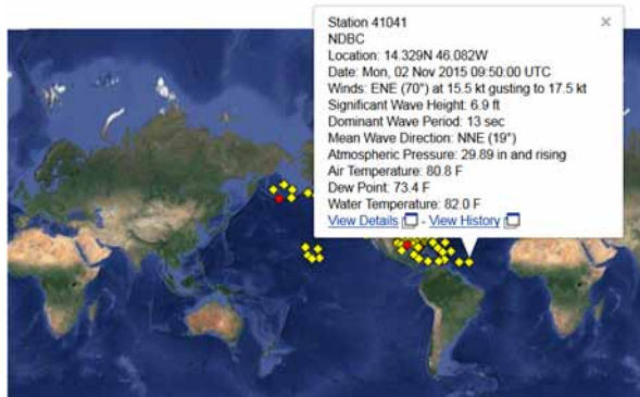
(شکل ۴) نمونه‌ای از پارامترهای اندازه‌گیری شده توسط بویه‌های مرکز NDBC
